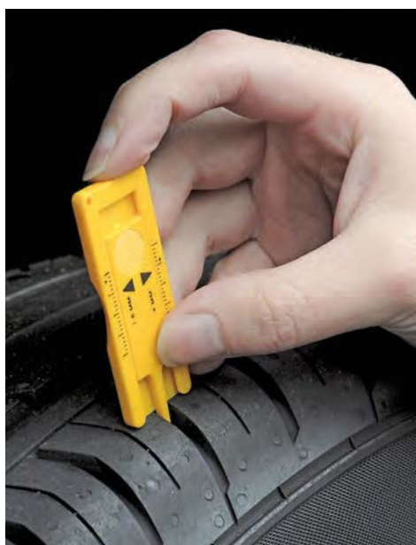
strumento per la misurazione dell'usura dei pneumatici
